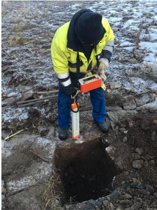
Bild 3: Haslach im Kinzigtal, Schnapperwehr, Überprüfung der Lage der Gasleitung durch einen Mitarbeiter der Fa. Terranets BW GmbH mit Hilfe des Messgerätes „Ferrolux FS10“.
