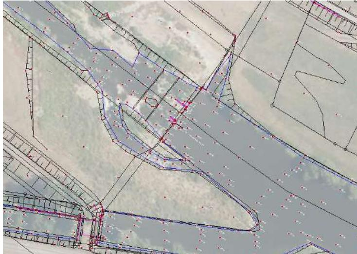
Abbildung 3-2: Ausschnitt Lageplan Vermessung Bestand (Ingenieurteam Trenkle 2014)
